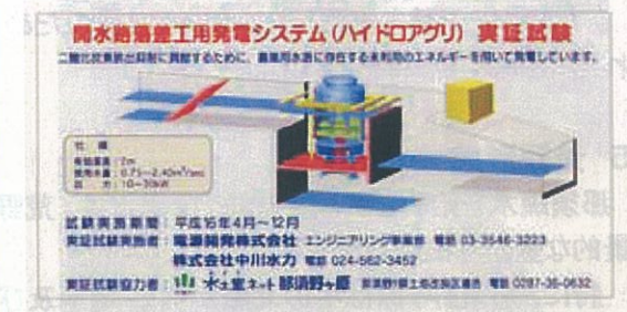
落差工を利用した発電システム (平成 17 年度設置: 4 基 = 120kw)
